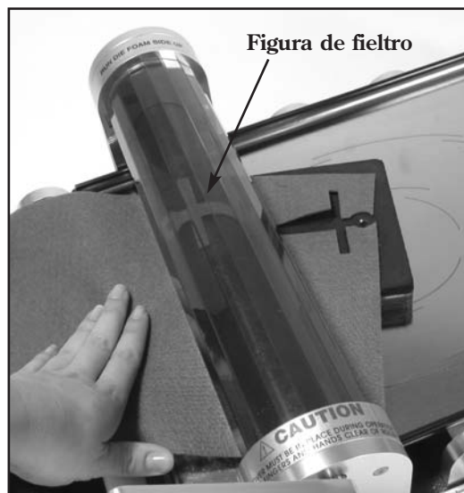
Figura 2: Los materiales fibrosos se pueden pegar al rodillo.
